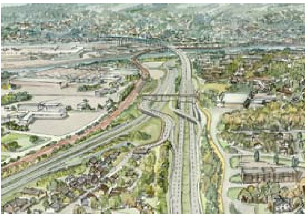
Utforming 7, Strandbrua direkteførte ramper
