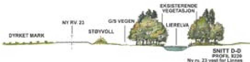
Snitt vest for Linnes med ny firefeltsveg og forslag til støyvoll
