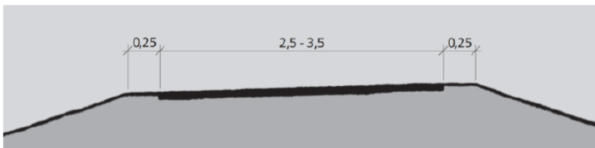
Figur 3: Anbefalt tverrprofil for gang- og sykkelvei (mål i m) fra Statens vegvesens Håndbok 017.
