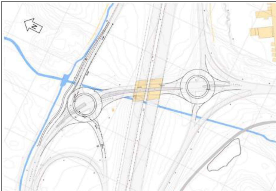
Figur 2-3 Alternativ 1 én rundkjøring på hver side av E18. Vannforekomster er tegnet inn i blått.
