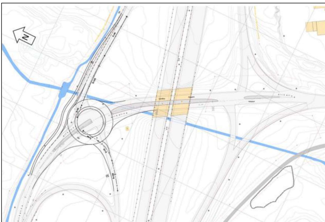
Figur 2-5 alternativ 3 Rundkjøring på nordsiden av E18 (til venstre i figuren). Vannforekomster er tegnet inn i blått.
