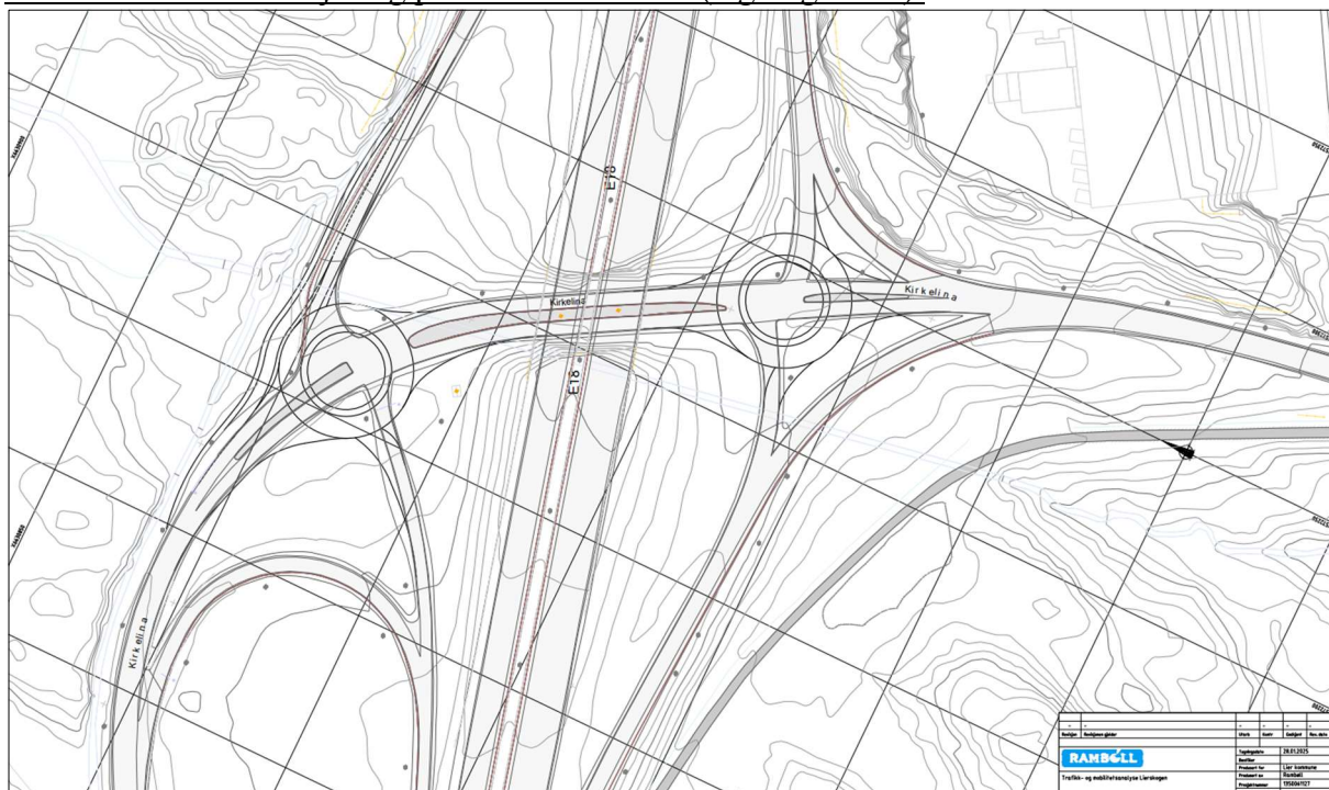
Tegning B101, datert 28.1.2025 viser alternativ 1: En rundkjøring på hver side av E18
