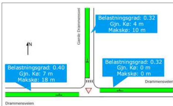
Figuren viser belastningsgraden i krysset Drammensveien x Gamle Drammensvei. Beregninger er gjort i SIDRA.
