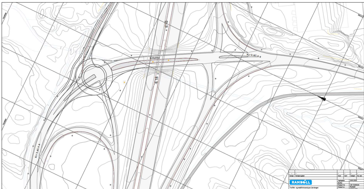
Tegning B103, datert 28.1.2025 viser alternativ 3: Rundkjøring nord for E18
