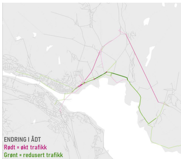
Figur 4-12: Endring i trafikkmengde som følge av redusert hastighet på Strandveien og eksis. E134.
