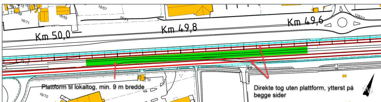
Figur 2-1 Prinsipp plattform kun til midtre spor (lokaltog)
