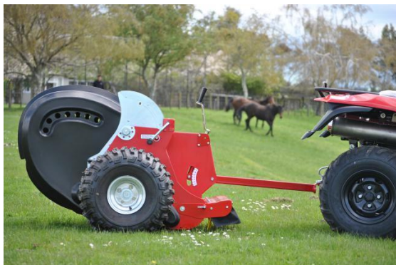
Figur 2 Det finnes flere ulike typer gjødselsamlere. Denne over er mekanisk opplukking, men du finner også typer som suger opp møkka. Denne på bildet trekkes av en firhjulig, og en kan fint manøvrere inne i en paddock.
