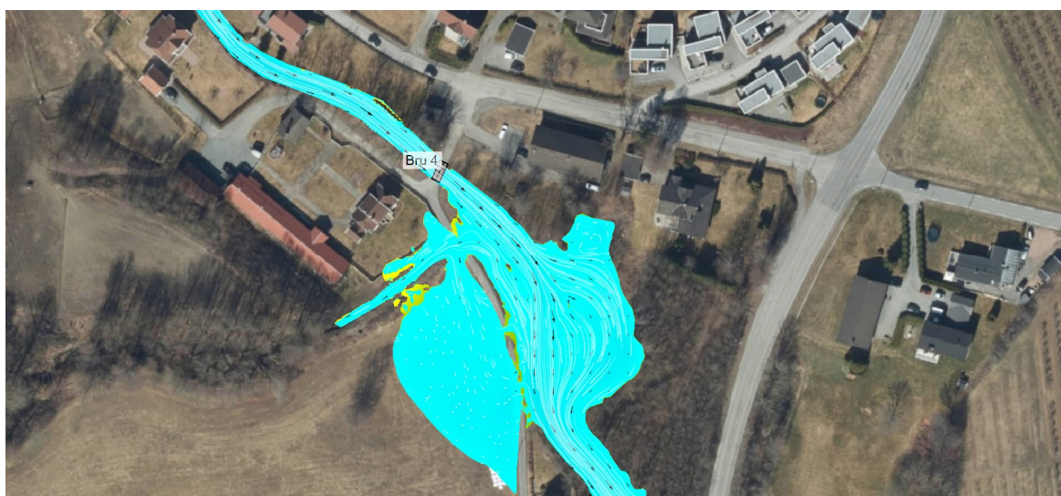
Figur 22 Flomutbredelse ved Q200Klima med hevet bro og mindre flomvoller på strekningen.
