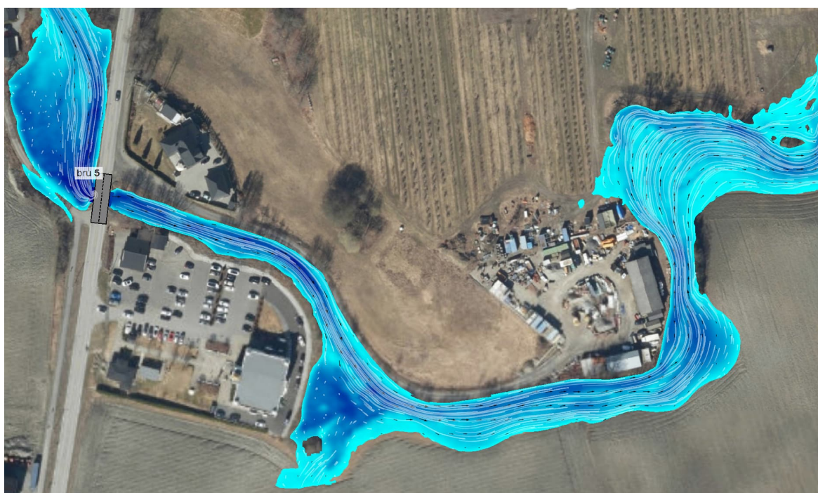
Figur 28 Flomutbredelse ved Q200klima etter foreslåtte tiltak med heving av vei og flomvoll.
