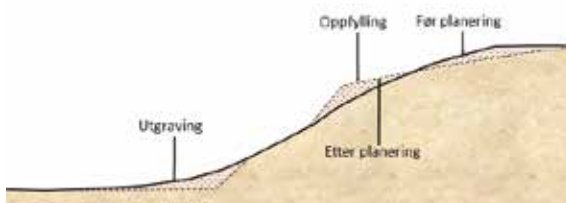
Figur 24: Planerings- eller oppfyllingsarbeid der stabiliteten svekkes.
