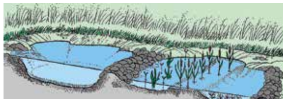
Figur 4: Skjematisk tegning av fangdam eller konstruert våtmark. Tegning Bent Braskerud
