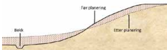
Figur 23: Typisk endring av stabilitet ved planeringsarbeider. I dette tilfellet blir stabiliteten bedret.
