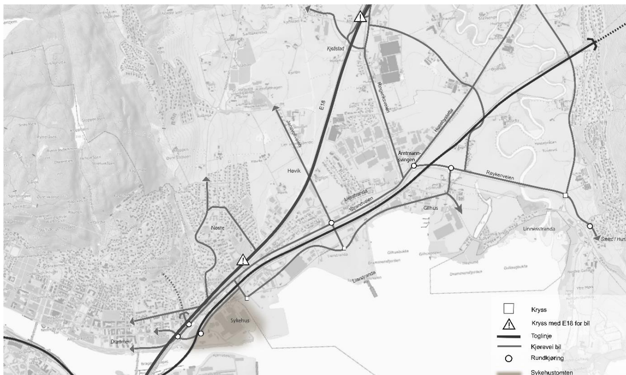
Figur 5-1: Skisse av veg- og kryssløsning for biltrafikk i Alternativ 2 fra mulighetsstudien.
