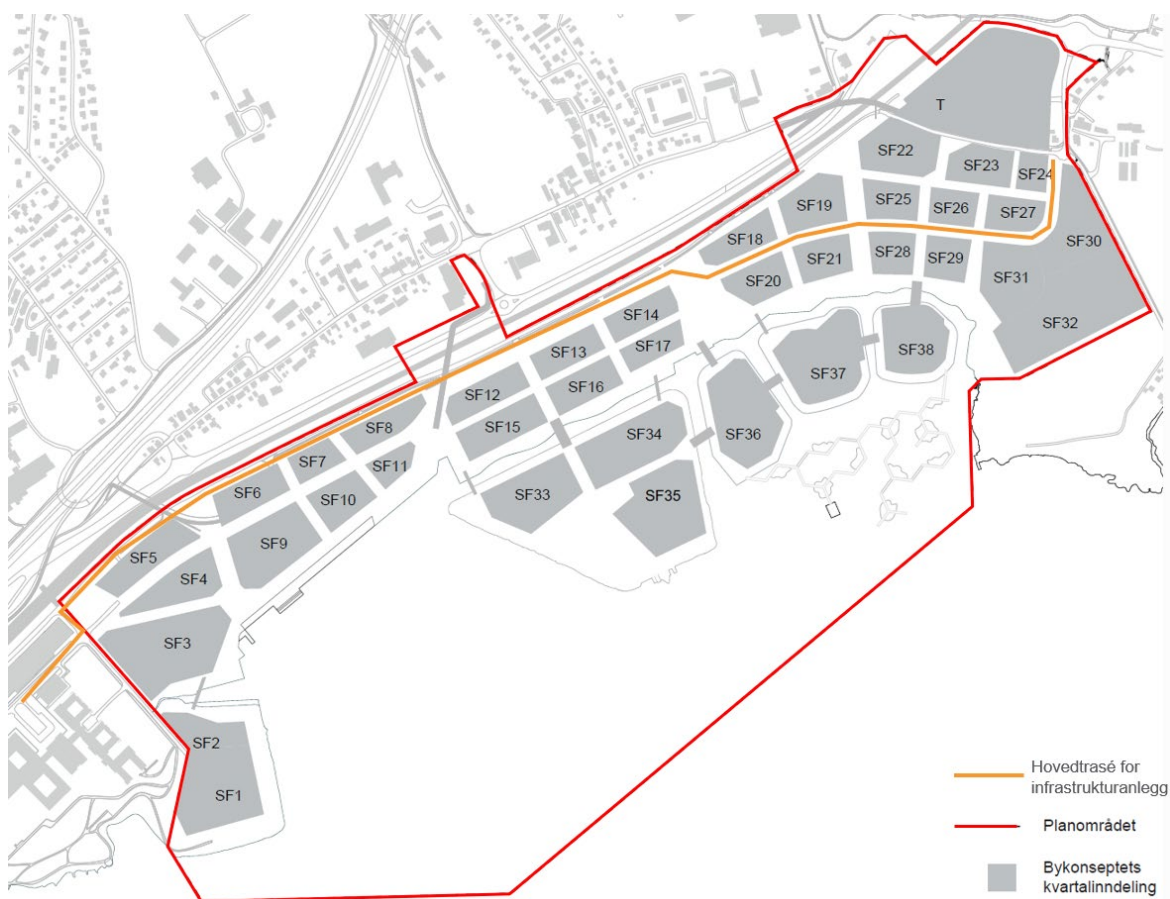
Figur 4-23. Forslag til hoved trase for teknisk infrastruktur.
