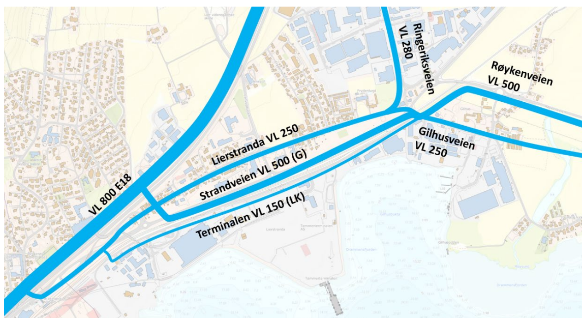
Figur 2-2. Eksisterende hovedledninger for vannforsyning.
