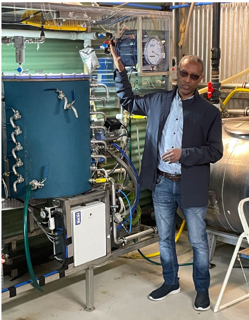
Figur 4-31. Melesse E. Moges viser frem svartvanstank og bioreaktor benyttet i svartvannsforsøk i SiEUGreen prosjektet. (Kilde: Jan Stefan Karlsson, Multiconsult)
