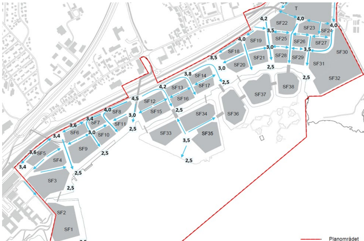
Figur 4-38. Høydeplan for å sikre flomavrenning på terrengoverflaten.
