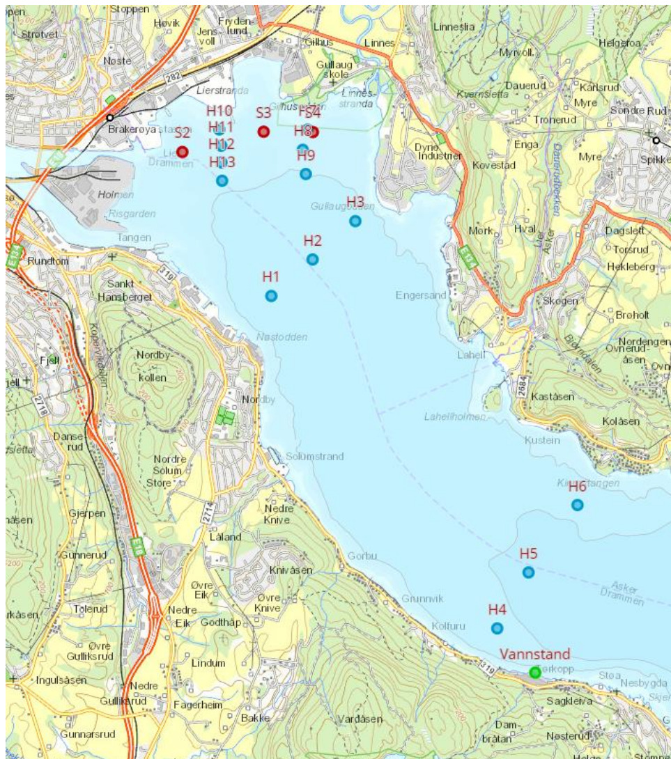
Figur 2: Kart som viser hvor det er gjennomført målinger. Tidsserier av strøm og hydrografi (røde punkter), hydrografiske profiler (blå punkter) og tidsserie av vannstand (grønt punkt)
