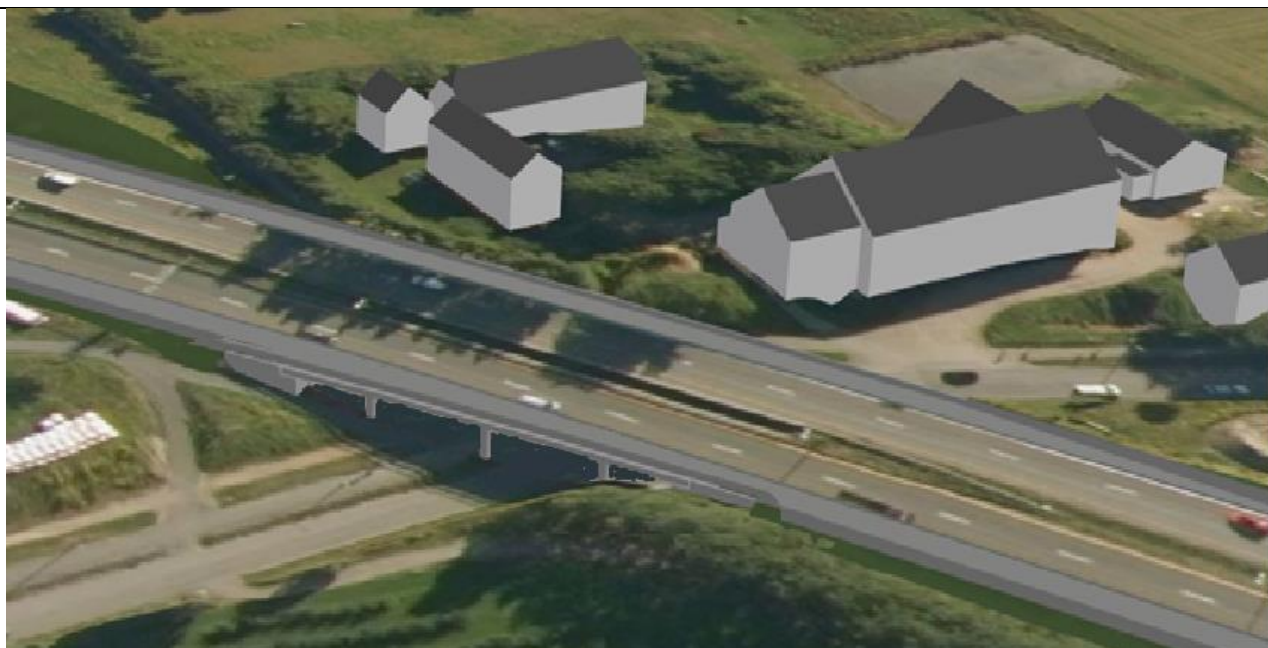
Figur 3-36 3D modell K1201 Breddeutvidelse av eksisterende bruer. Til orientering ligger Jensvoll gård midt i bildet.
