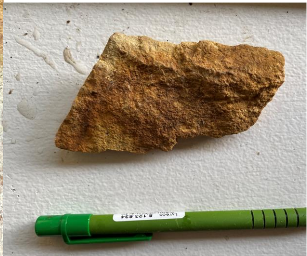
Figur 5-15 Bergskjæringer hvor det er observert med gul rustutfelling på overflaten. Se Figur 5-14 hvor stedet er merket på kartet.
