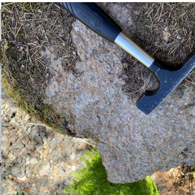
Figur 5-4 (v) Fin-middelskornet granitt med lavt innhold av kvarts og biotitt i bergmassen.
