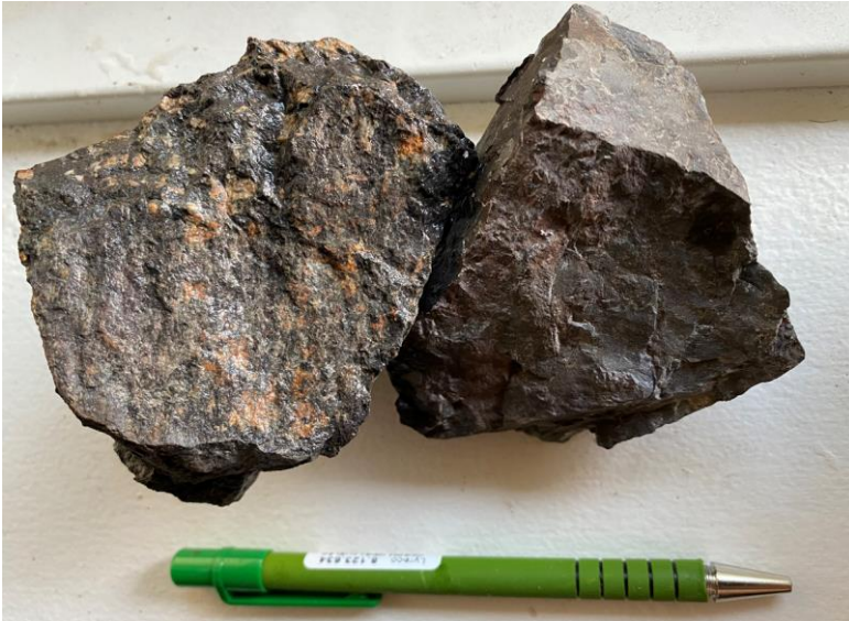
Figur 5-8 Syenittporfyr. De rosa porfyrene i berget er antatt feltspat.
