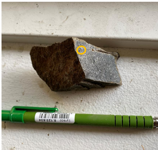
Figur 5-6 Finkornet diabas med noe gule «pyritt»-prikker i bergmassen.
