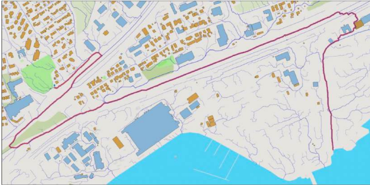
Figur 33. Eksisterende flomvei til resipient simulert med SCALGO Live.
