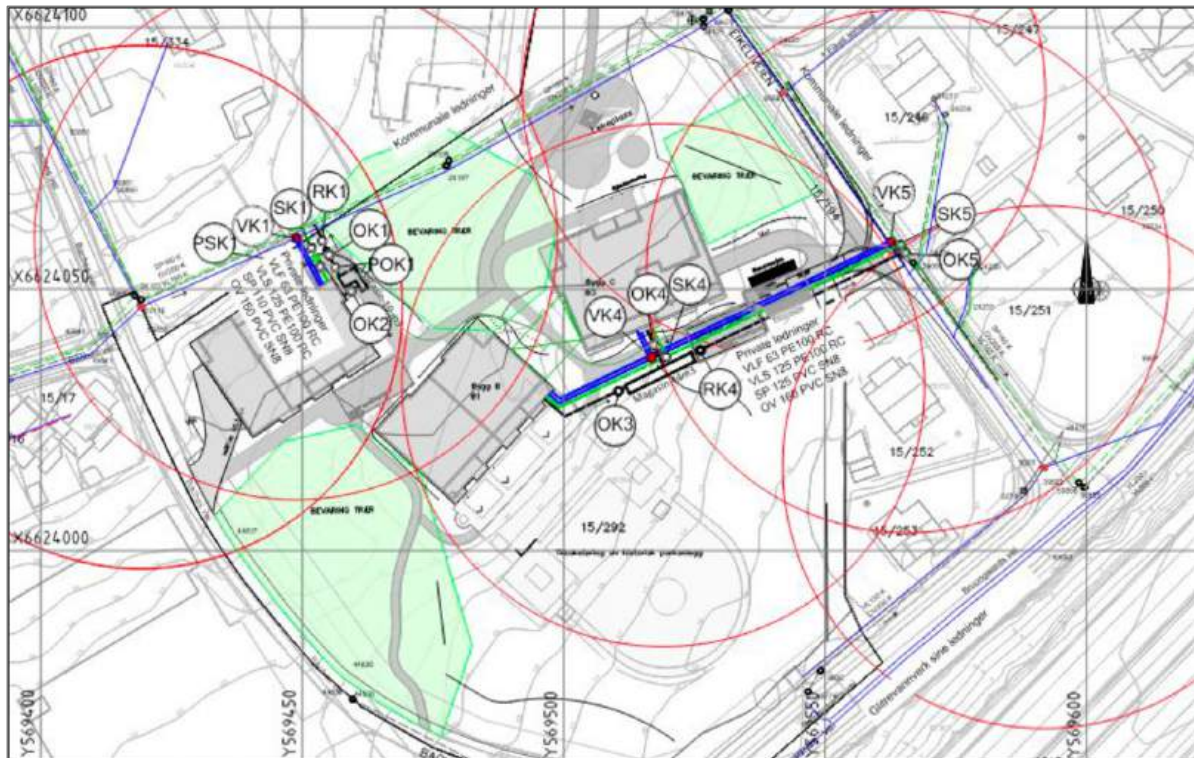
Figur 53. Brannvannsdækning, det er behov for en ny brannkum sør for bygget i øst.
