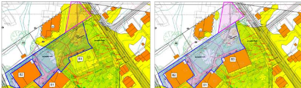
Figur 71. Støyberegning, situasjon vist med to og tre bygg. Tre bygg viser en klar forbedring av støysituasjon.
