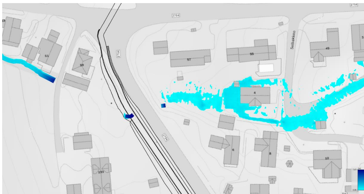
Figur 5-5 -Figur 5-4- Flomsituasjon etter utbygging av røret (1400mm) og ny GS vei. Q_{\text{dim}} = 1.5 \text{ m}^3/\text{s} .
