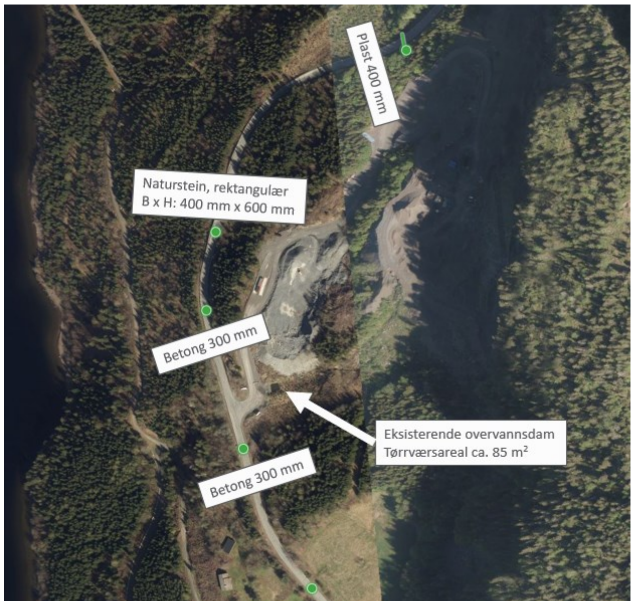
Figur 4: Eksisterende overvannsdam og stikkrenner ved massedeponiet på Toverud. Stikkrenneplassering og dimensjon er hentet fra Statens vegvesens Vegkart
