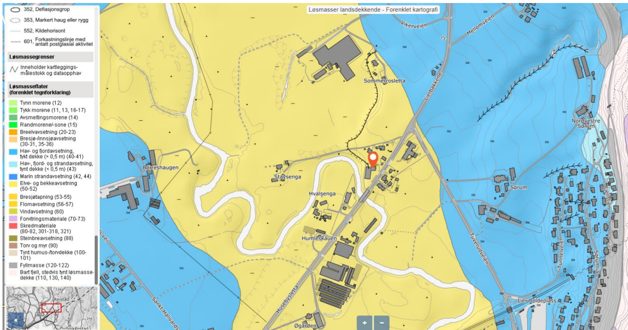
Figur 4: Kvartærgeologisk løsmassekart fra NGU viser at det kan forventes elve- og bekkeavsetninger i øvre lag. Det kan ikke utelukkes at det er marine avsetninger med mulighet for kvikkleire i dybden. Fra www.ngu.no [2]
