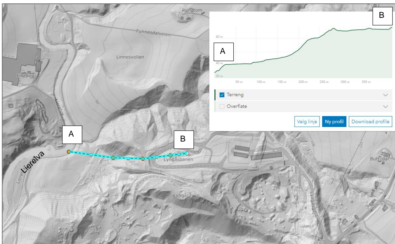
Figur 9: Kart fra Høydedata som viser konturene av landskapet ved Lyngås. Figuren viser også avstander og terrengprofil fra tiltaksområdet ved B og ned til Lierelva.
