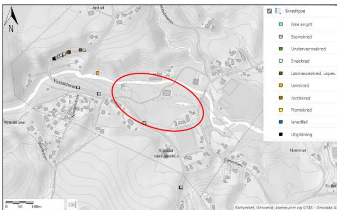
Figur 6-22 Skredhendelser i nærheten av planområdet. Byggeområdet i planen angitt med rød oval. Kilde: Terraplan.
