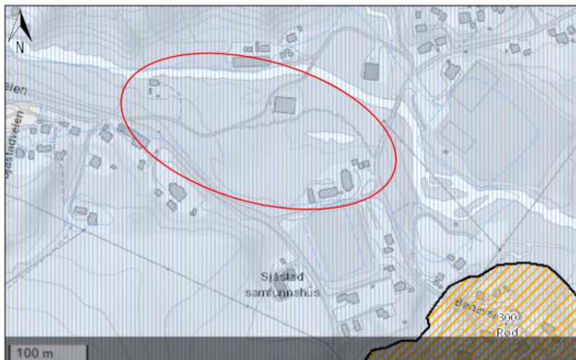
Figur 6-23 Kart fra NVE sine sider viser kartlagte kvikkleiresoner (gul skravur) i nærheten av planområdet. Byggeområdet i planen markert med rød ring. Kilde: Terraplan.
