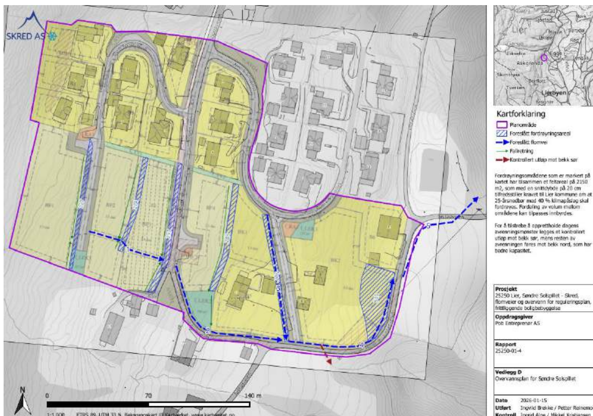
Figur 54: Overvannsplan for Søndre Solspillet (Skred AS, 2026).
