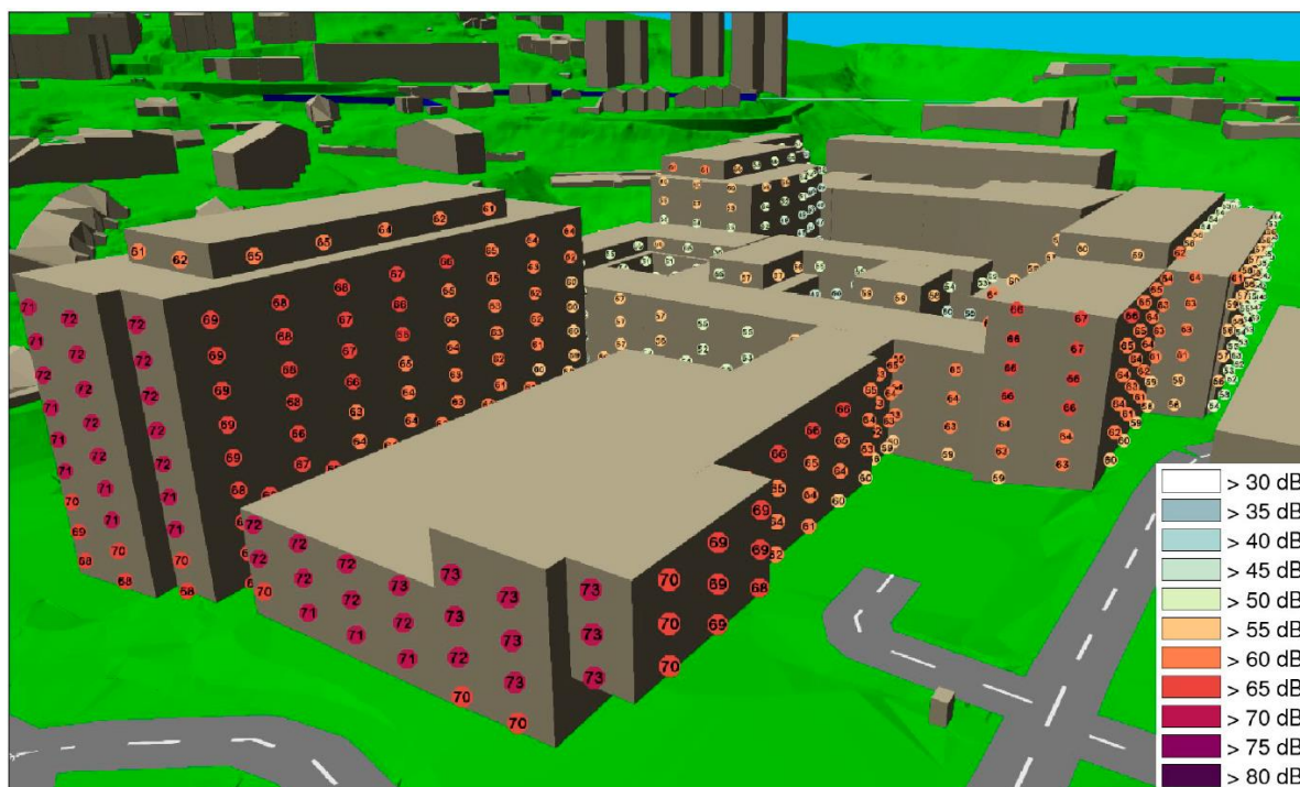
Figur 3-14: Støynivåer på fasade for planforslag Radiumhospitalet. Nytt sengebygg er bygget lengst til høyre
