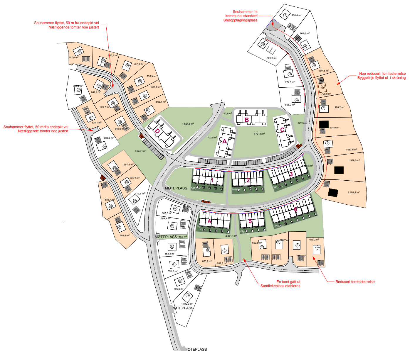
Fig. A: oversikt over endringer i alternativ 1. Oransje tomter viser de tomtene som har redusert tomteareal
