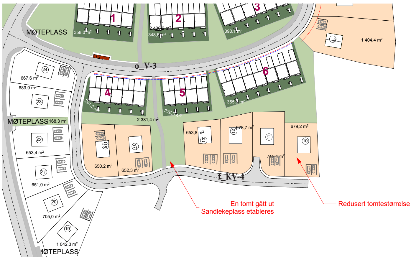
Fig C: Område langs f_KV_4, felt BF-8, BF-9, BF-10: En eneboligtomt har gått ut. Skulder for snøopplag er lagt inn langs f_KV_4 Det etableres sandlekeplass i overgangen mellom eksisterende Bøveg og videre gangforbindelse nordover.
