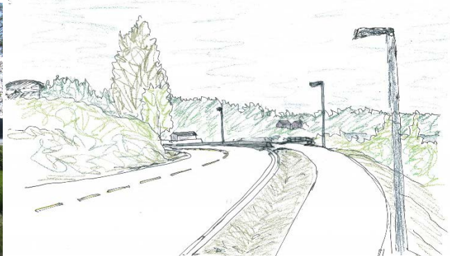
Bilde 9 og 10. Svingen forbi Ulvenvannet. G/s-vegen legges på en fylling på utsiden av eksisterende veg. Ny avkjørsel til eiendom 158/4 etableres i svingen.
