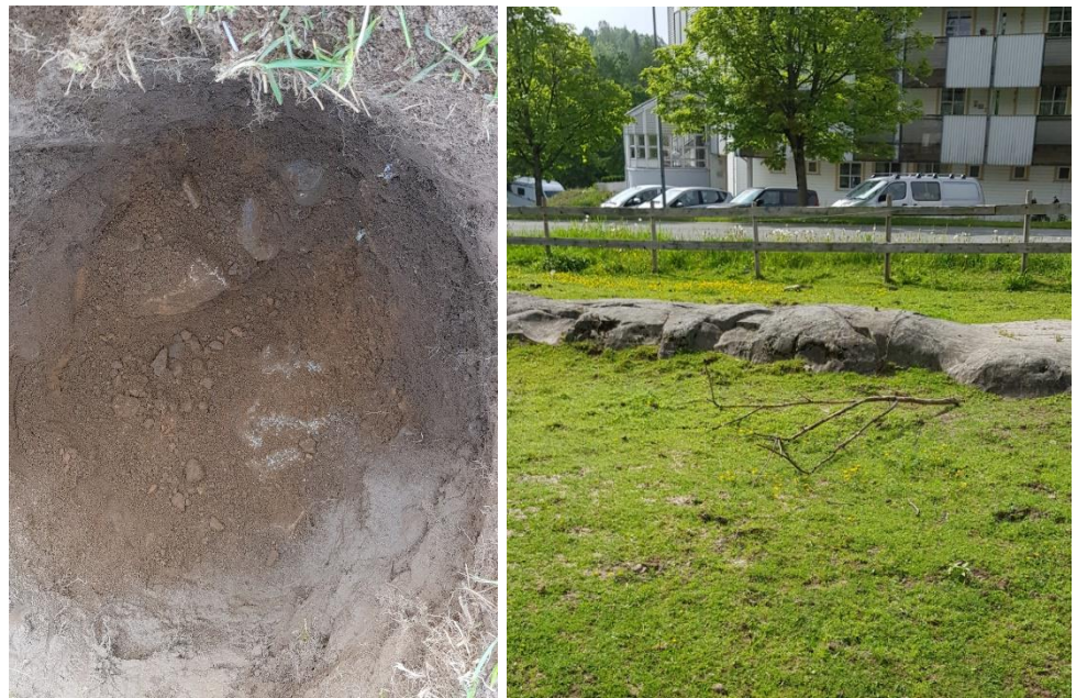
Figur 7. Bildet til venstre viser graveprøve tatt på beiteområdene øst på Haugerudbråtan (P1). Tre «skraper» i bunnen på gropa viser fjell rett under overflaten, ved ca. 30 cm dybde. Bildet til høyre viser fjell i dagen, øst på tomta.
