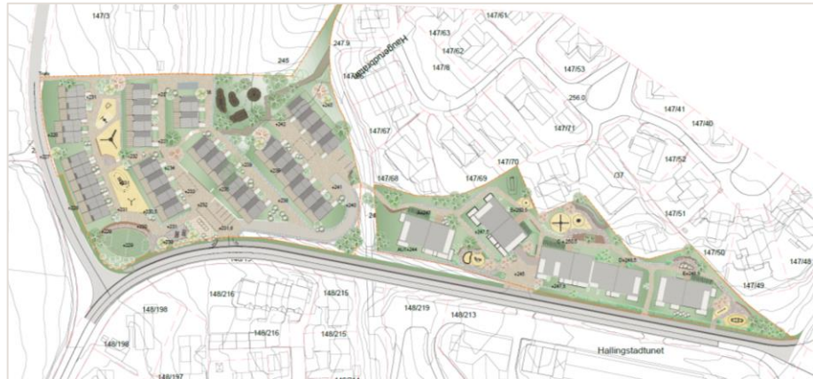
Figur 2: Situasjonsplan. Det skal bygges fire blokker på østre del, samt åtte rekker med rekkehus på vestre del.
