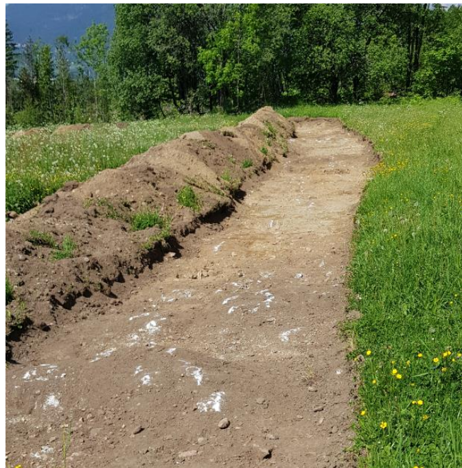
Figur 16 viser geologiske undersøkelser på tomte. Det er kun et tynt jorddekke over fjell i dagen.
