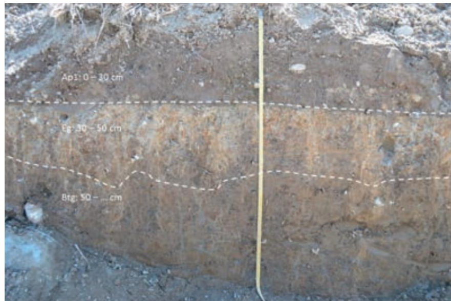
Figur 19 viser eksempel på matjordprofil av leirjord. Fra Holstad, Ås. (Foto: Trond Knapp Haraldsen, kilde: Fylkesmannens veileder for planering og jordflytting, NIBIO).
