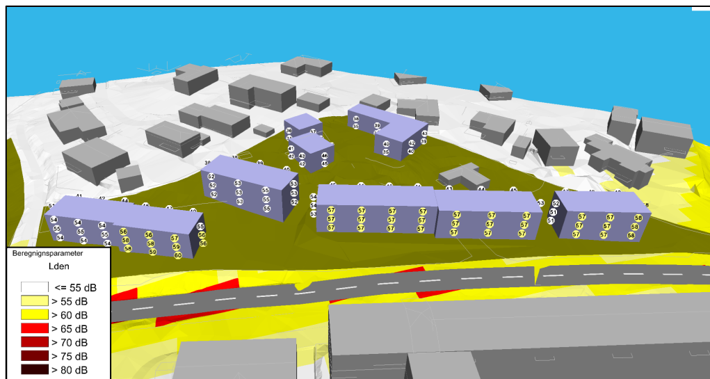
Figur 2: Støynivå Lden på fasader mot Bratromveien for BKS2.
