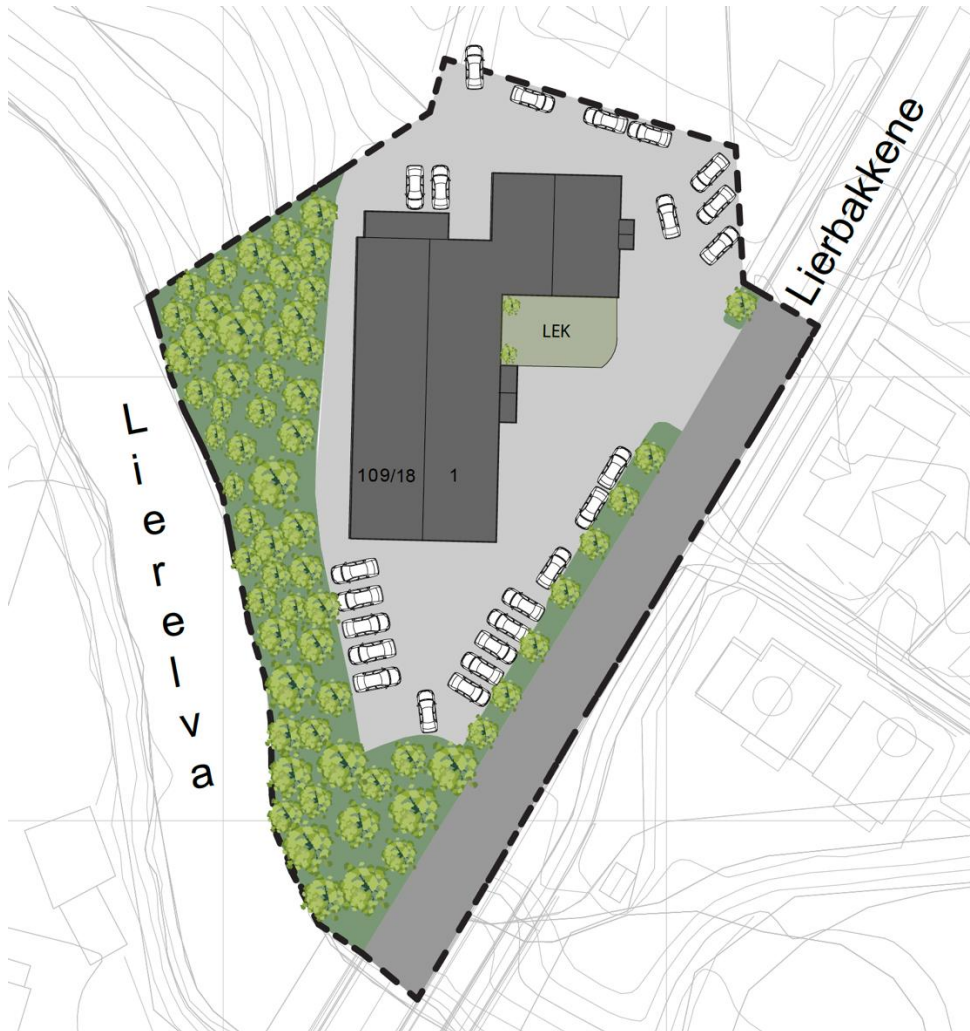
Figur 24: Illustrasjonsplan med nytt inngangsparti, lekeområde og påbygget lagerbygg. Eksisterende avkjørsel i syd er stengt.
