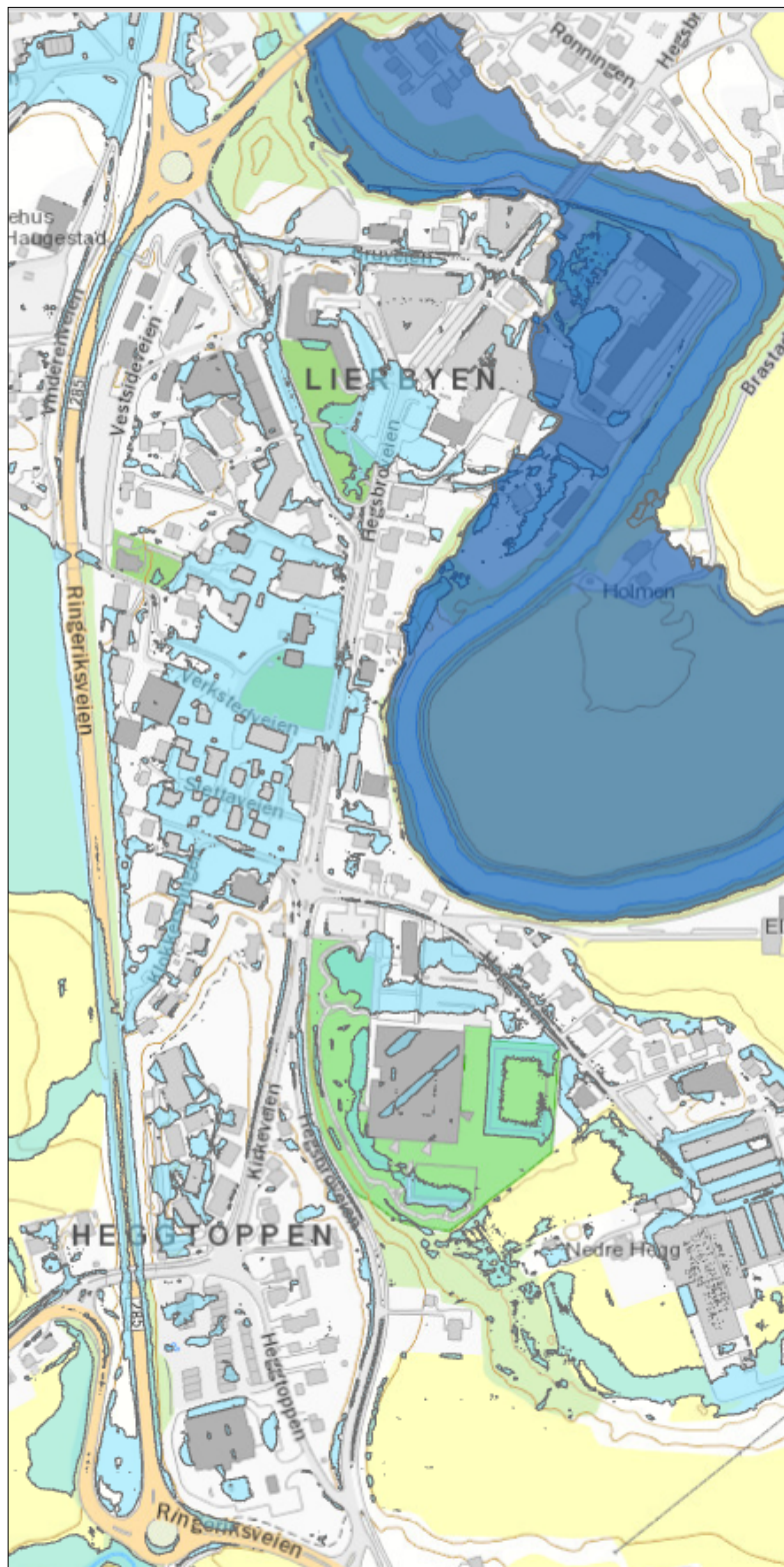
Figur 11. Overvannsflom ved 200-års nedbørshendelse inkludert klimapåslag 50 %. Lyseblå arealer viser overvannsflom mens mørkeblått viser elveflom.
