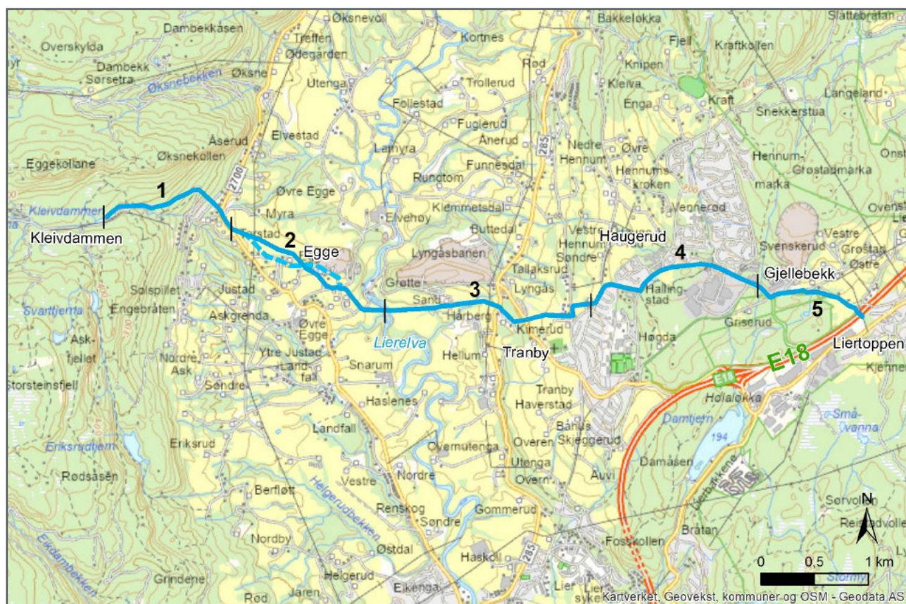
Figur 1-1 Kart over planlagt trasé for ny hovedvannledning fra Kleivdammen i vest til Liertoppen i øst (alternativ 1). Delstrekninger er angitt med tall 1-5. Se Figur 1-2 til Figur 1-6 for mer detaljerte kart over hver delstrekning og de to variantene på delstrekning 2.
