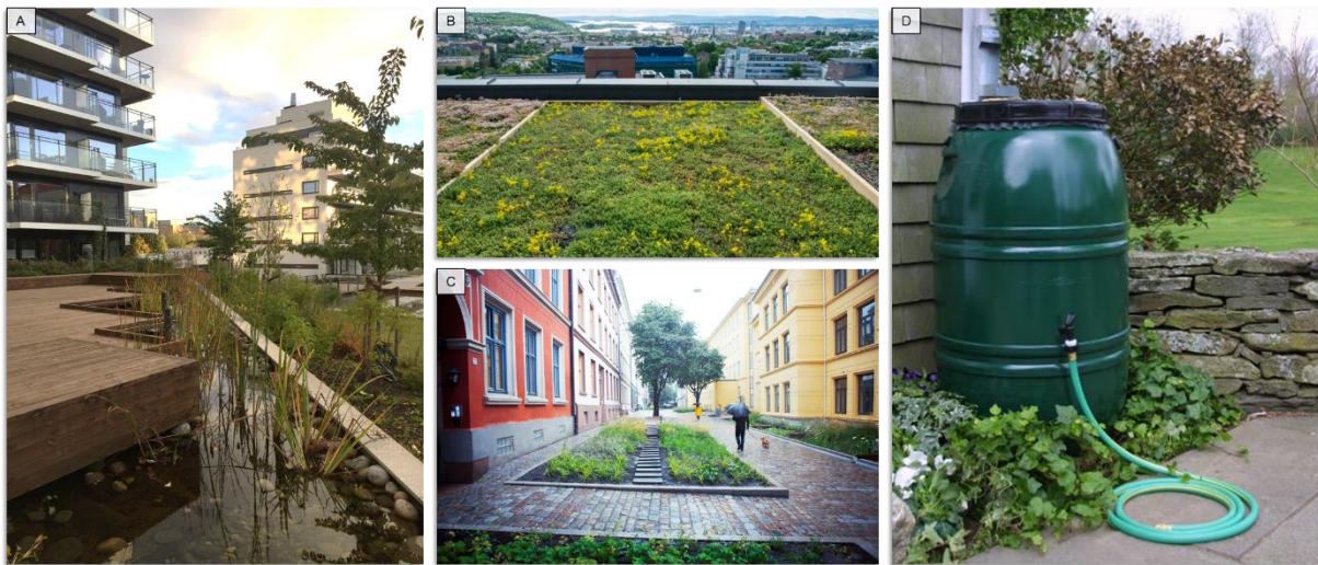
Figur 4: A: Åpen overvannshåndtering kan bidra estetiske kvaliteter gjennom permanente vannspeil (Foto: Kim H Paus). B: Grønne tak med liten vekstdybde bidrar til at mindre regn fanges opp og fordampes (Foto: Bård Bredesen / Naturarkivet). C: Regnbelt i Deichmansgate bidrar til at mindre regn infiltreres, fordampes og forurenset avrenning renses (Foto: Åse Holte). D: Oppsamling i regntønner er et eksempel på å bruke vannet som ressurs (Foto: Buffalo Niagara Riverkeeper).
